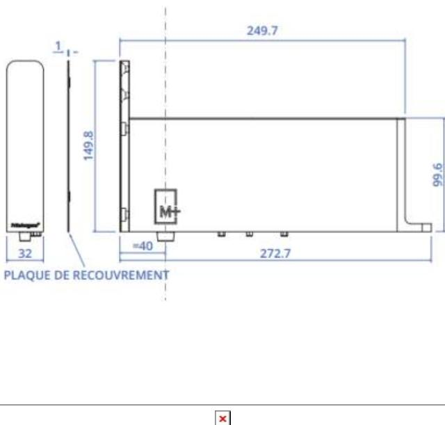
Ensemble pivots de porte complet "Système M" STM+40-AA, offrant 1 fonction ferme porte avec freinage à l'ouverture et blocage à 90° et -90°. Gâches rectangulaires au sol et au plafond.
