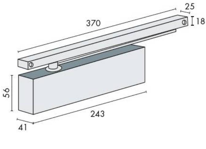
Ferme-porte à bras à glissière à crémaillère elliptique, force 1-4 suivant norme EN 1154 A. Réglage de la vitesse de fermeture et de l'à-coup final par vis, freinage à l'ouverture non réglable, capot anti-vandalisme. Pour portes de largeur maximum : 1100 mm
