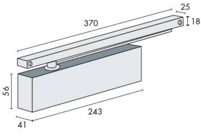
Ferme-porte à bras à glissière à crémaillère elliptique, force 1-3 suivant norme EN 1154 A. Réglage de la vitesse de fermeture et de l'à-coup final par vis, freinage à l'ouverture non réglable, capot anti-vandalisme. Pour portes de largeur maximum : 950 mm
